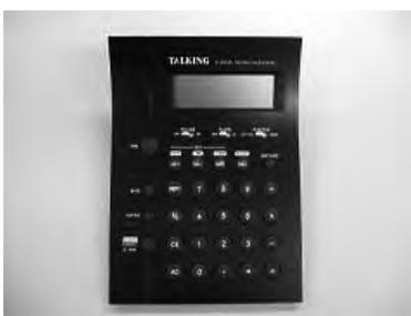
キーを打つと、音声で「押したキー」や「計算結果」などを読み上げる、時計機能・アラーム機能の付いた10桁の小型音声電卓です。
